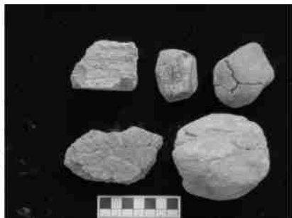
图 2 出现龟裂纹的烧石
